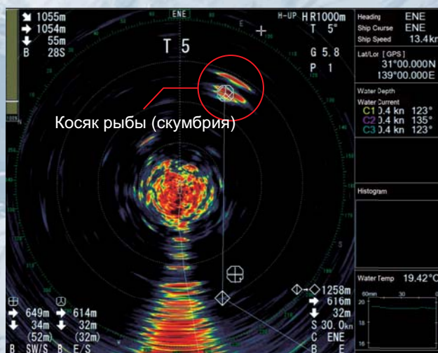
(Дальность 1000 м). Обнаружение косяка рыбы на расстоянии в 650 метров.
